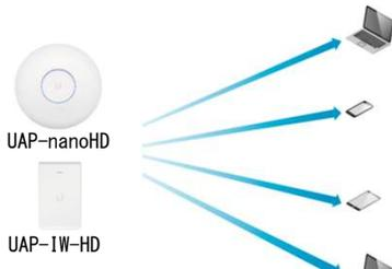
・ 1x1クライアントのMU-MIMO：各クライアントラジオは、一度に4つの1x1クライアントと通信します。
