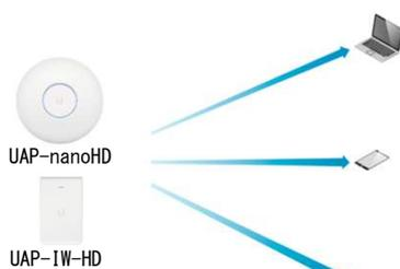
・ 2x2および1x1クライアントのMU-MIMO：各クライアントラジオは、一度に1つの2x2クライアントと2つの1x1クライアントと通信します。
