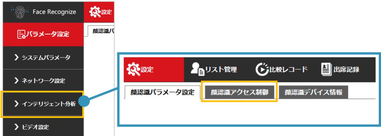
2. 中央部の<アクセス制御>内の<開始条件>で、[ホワイトリスト+ドアを開くための顔認証]を選択し、[保存]をクリックします。
