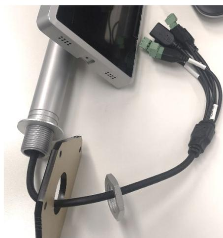
7. スタンド内のコネクタ(電源とUSB)とカメラ側のコネクタを接続します。また、必要に応じて設定変更用パソコンに繋ぐためのLANケーブルをカメラ側コネクタに接続します。
