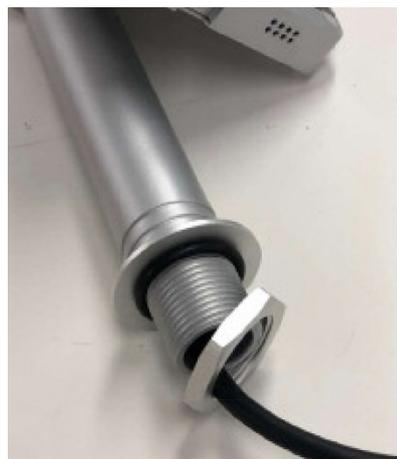
5. コネクタ部をナットに通し、ナットを抜き取ります。
