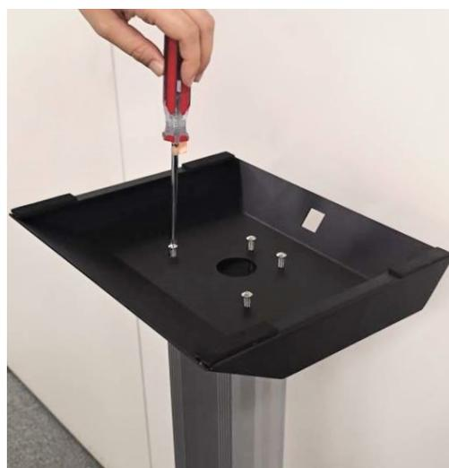
3. スタンドを立て、上部のネジ4点を緩め、カバーを外します。※固くはめ込まれていますので、取り外す際は注意してください。
