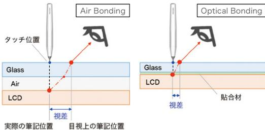
ガラスとLCDの間に空気層をなくし、見た目と実際の筆記位置のギャップを極小化。さらに、よりガラスに近い位置に赤外線走らせるInGlassテクノロジーを採用することで、筆記しやすさを向上しています。また、空気層への粉塵混入が低減される為LCDの劣化耐性が向上しました。
