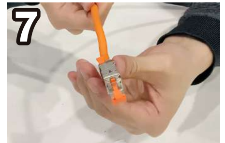
RVAIP2SME(RJ45 プラグ)にはめ込んで完成です。もちろん、RVAIP2SME(RJ45 プラグ)の取り外しや付替えも可能です。
