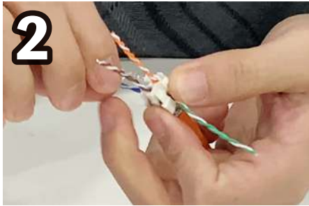
「ケーブルマネージャー」の色に沿って、ペアの絶縁体を通します。
