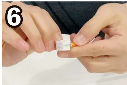
「コア」が完成します。再施工する場合はコアを切り取ってから、新たなコアを作成します。
