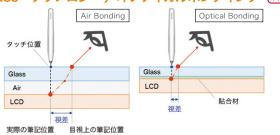
ガラスとLCDの間に空気層をなくし、見た目と実際の筆記位置のギャップを極小化。さらに、よりガラスに近い位置に赤外線を走らせるInGlassテクノロジーを採用することで、筆記しやすさを向上しています。また、空気層への粉塵混入が低減される為LCDの劣化耐性が向上しました。
