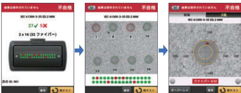
FI2-7300 FiberInspector MPO 端面検査カメラのライブ・ビュー機能を使って MPO 端面全体の表示 (左) とピンチ操作による拡大表示 (中央)、さらに特定のファイバーの拡大表示例 (右)
